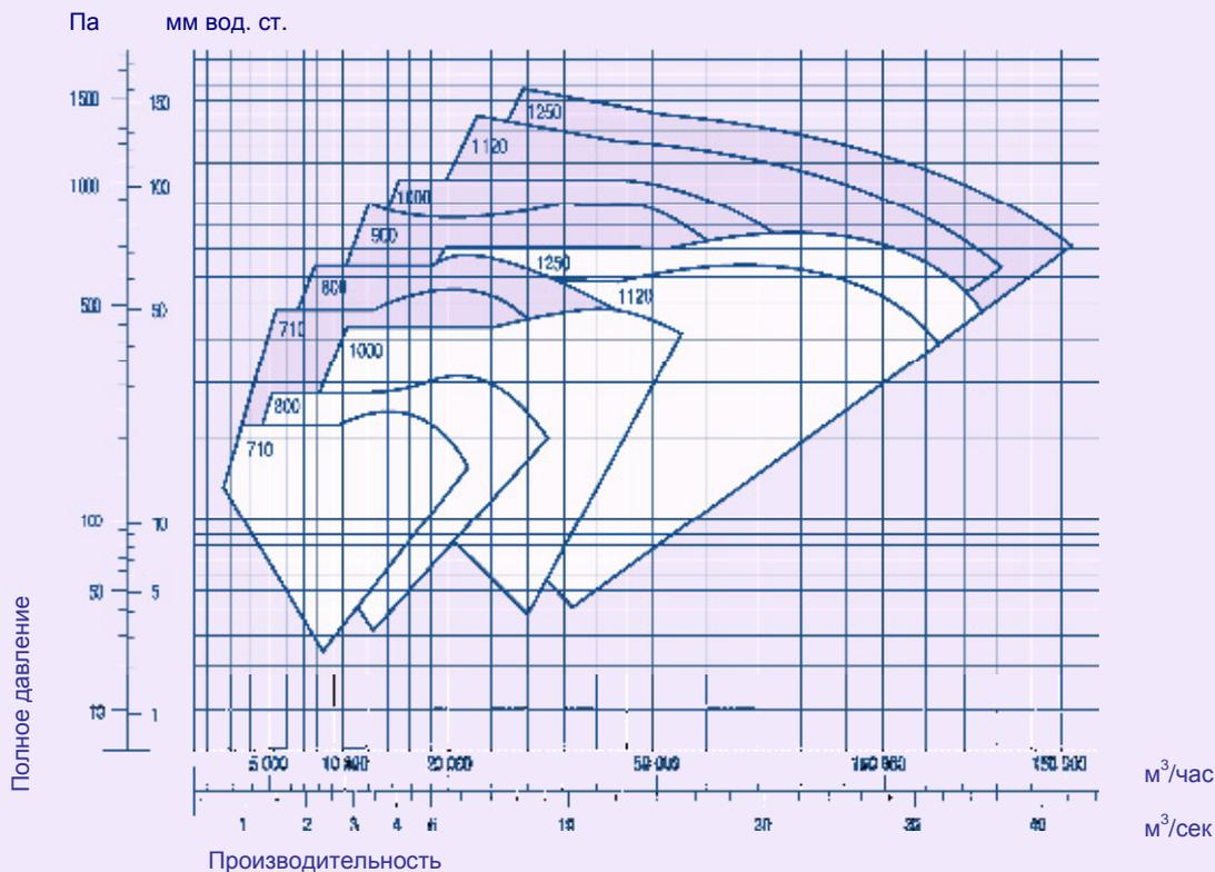
Рис. 7 Сводные графики характеристик вентиляторов Аксипал с размерами рабочих колес от 710 до 1250 мм
