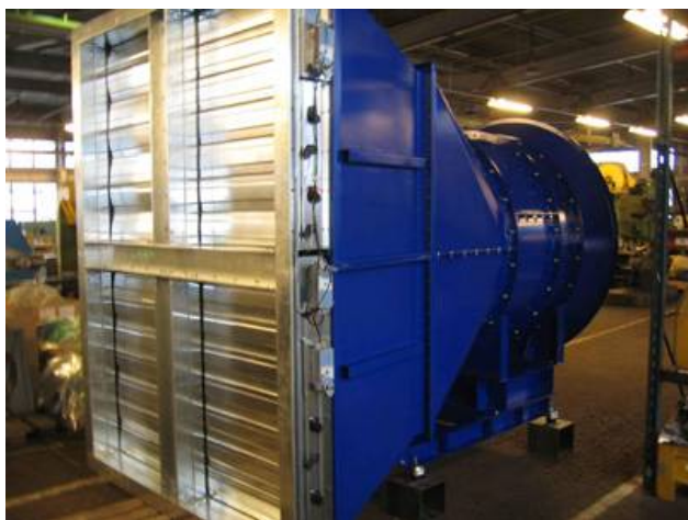
Реверсивные туннельные вентиляторы FTDA-REV с прямоугольными клапанами.
